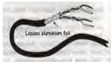
Gbr. Kabel STP
