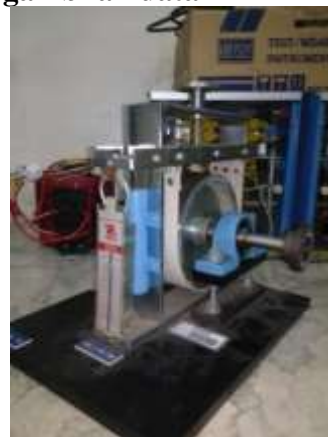
Gambar 13. motor beban dengan prony-break
