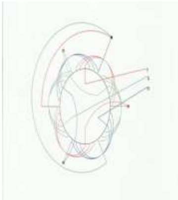
Gambar .6 bentuk wiring gulungan Rpm 1500
