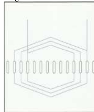
Gambar .5 bentuk serie dalam sebuah gulungan
