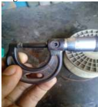
Gambar .2 Bentuk nyata ukuran kawat Dari gambar diatas menunjukkan bahwa ukuran kawat adalah 0,45 mm, sebenarnya kawat yang diukur adalah 0,40 mm. Mengapa gambar tersebut menunjukkan ukuran 0,45, sebab ketebalan isolasi kawat adalah 0,05 mm. Namun perlu diperhatikan pula merk kawatnya, setiap merk kawat memiliki ketebalan isolasinya masing – masing tetapi perbedaan selisih isolasi tidak terlalu jauh antara 1 : 2 saja.
