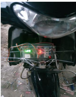
Gambar 4.4 Penempatan Mikrokontroler di sepeda motor.
