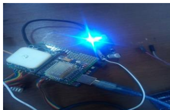
Gambar 4.2 Rangkaian Mikrokontroler dan GPS Neo 6m Unblok dengan DC Stepdown Converter.
