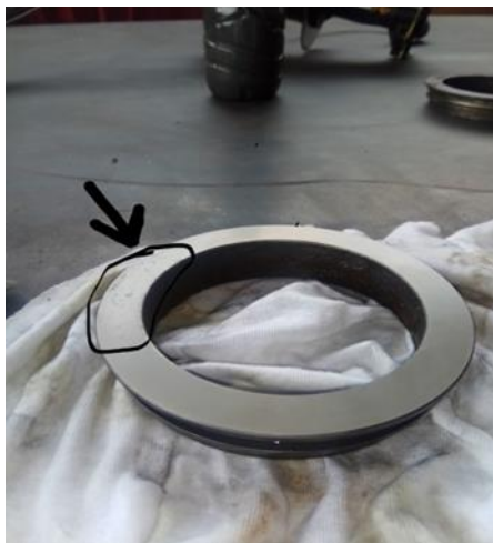
Gambar 5 Kerusakan Pada Gate Valve dan Dudukan (Seat)
