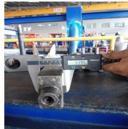
Gambar 9 Keausan Gate Valve Yang Telah Terpakai
