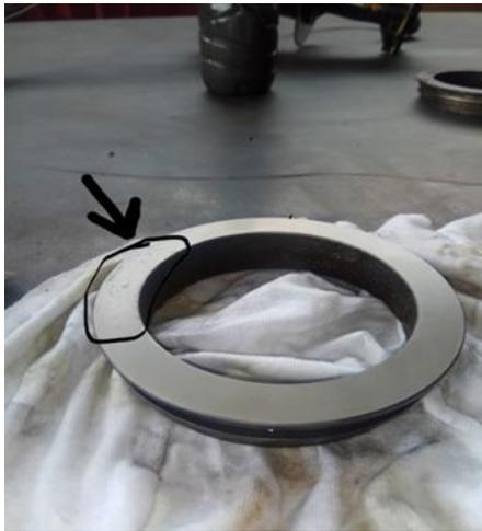
Gambar 5 Kerusakan Pada Gate Valve dan Dudukan (Seat)
