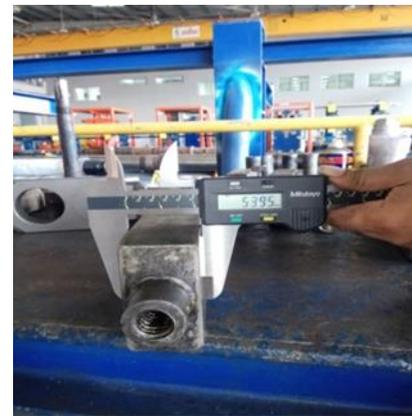
Gambar 9 Keausan Gate Valve Yang Telah Terpakai
