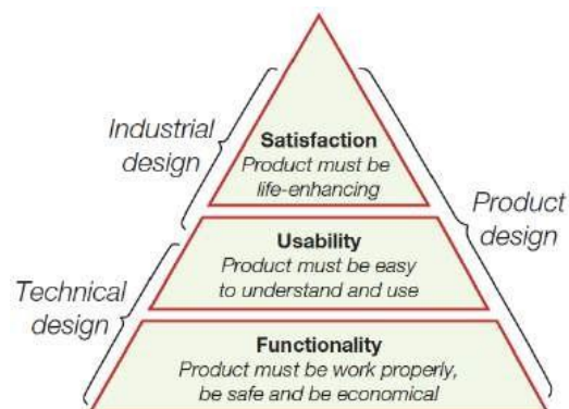
Gambar 14.2. Persyaratan piramida. Bagian bawah piramida disebut "desain teknis," bagian atas "desain industri." Ketiga tingkatan membentuk satu proses yang disebut "desain produk."
