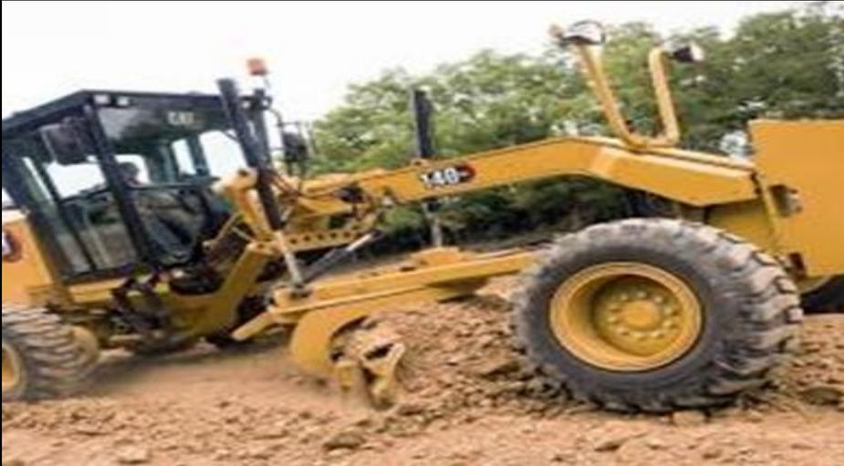
Motor grader digunakan untuk meratakan permukaan tanah untuk kehutanan
