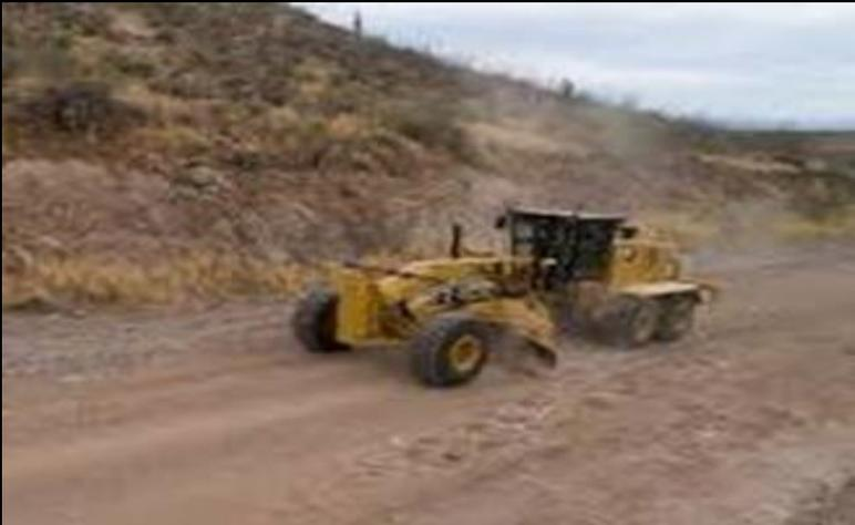
Motor grader digunakan untuk meratakan permukaan tanah untuk penambangan batubara
