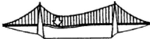
**Gambar 3.4** Beban hidup dapat berpindah-pindah & seringkali berupa beban terpusat. Apabila dek jembatan tidak kaku, maka kabel & juga dek jembatan akan berubah bentuk pada saat mengalami beban hidup.
