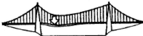
**Gambar 3.5** Membuat dek jembatan kaku pada arah longitudinal, gaya-gaya pada kabel yang disebabkan oleh beban terpusat akan terdistribusi secara lebih merata. Bentuk kabel & bentuk dek akan *relative* konstan.
