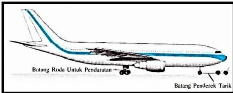
**Gambar 2.6** Elemen struktur yang mengalami beban aksial (batang penderek, mengalami tarik & batang roda pendaratan mengalami tekan)
