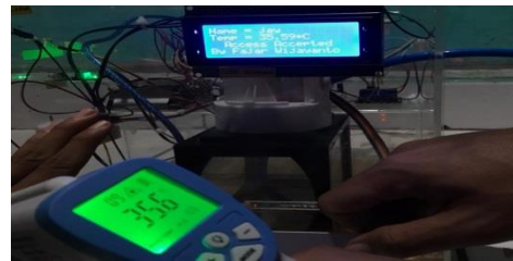
Gambar 4. 6 Perbandingan Sensor AOMAS HK-307 dan GY-906
