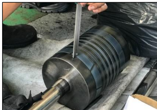
Gambar 9. Kondisi Ring Piston Setelah Diganti
