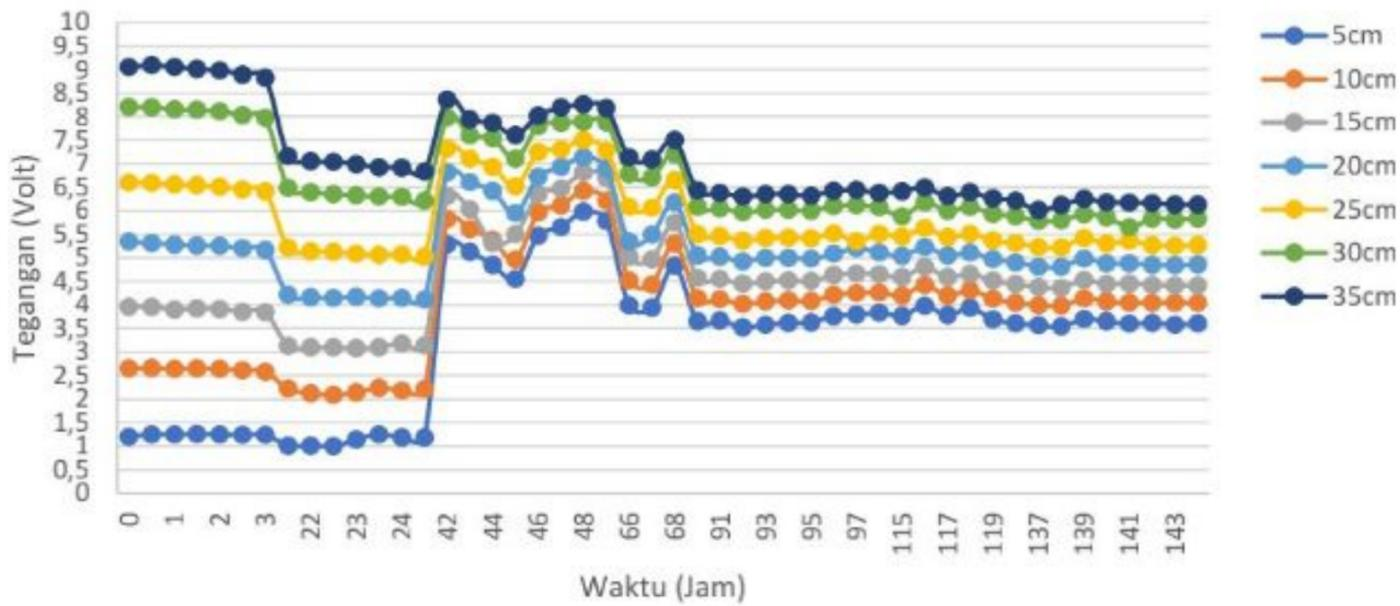
Gambar 4 tegangan yang terjadi pada setiap 50mm tembaga sampel tanah sta.2
