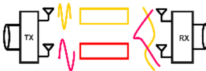
Gambar II.14 Sistem MIMO dengan Spatial Multiplexing
