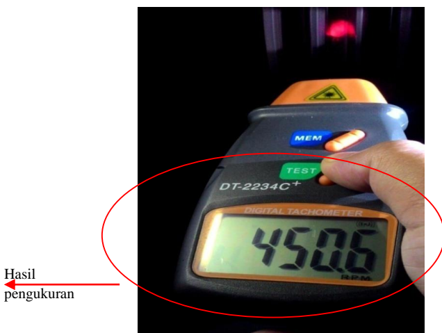
Gambar 7. Langkah Percobaan Kelima Dari percobaan di atas maka diperoleh data hasil pengukuran kecepatan putaran motor berdasarkan frekuensi perhatikan tabel 1.
