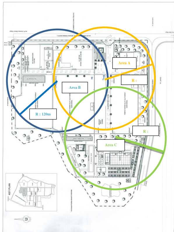
Gambar 10. Area Proteksi Terminasi Udara Elektrostatik.
