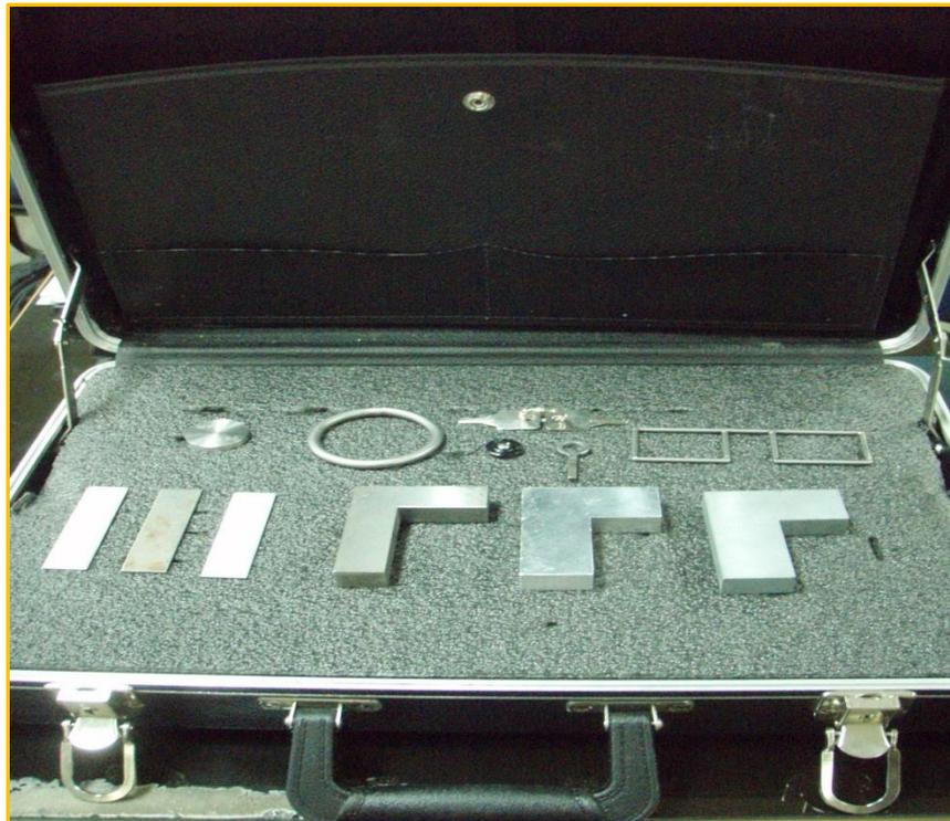
Gambar 3.19. Salah satu model *Object Test Piece* (OTP)
