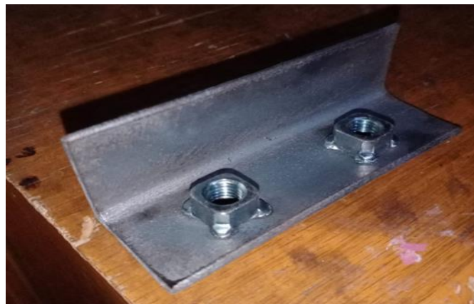
Gambar 4.4 pengelasan siku bracket Nut M8
