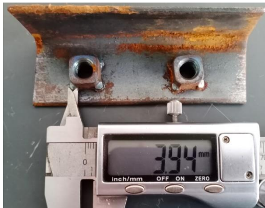
Gambar 4.6 ukuran sudut nut M8
