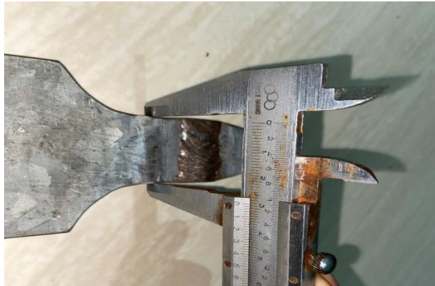
Gambar 4. 9 Pengukuran Lebar Awal
