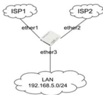
Gambar 2.1 Contoh topologi menggunakan load balancing
