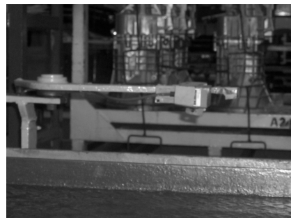
Gambar 4 Proximity switch pada Mesin Rotator Chassis.
