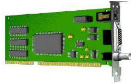
Gambar 11.4 Kartu Jaringan Ethernet Dari Atas Ke Bawah : konektor RJ-45, konektor AUI, dan konektor BNC
