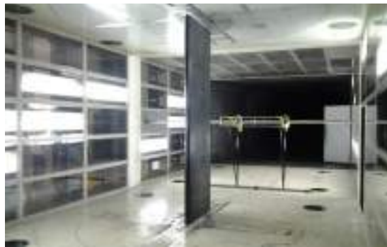
Gambar 7 Model sayap 2-D dengan wake rake di dalam seksi uji ILST
