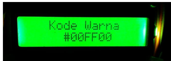
Gambar 12. Tampilan Saat Sensor Mendeteksi Barang Kode Warna Hijau
