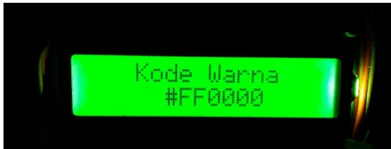
Gambar 8 Tampilan Saat Sensor Mendeteksi Barang Kode Warna Merah
