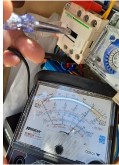
Gambar 3. 20 Pengujian kontaktor ON
