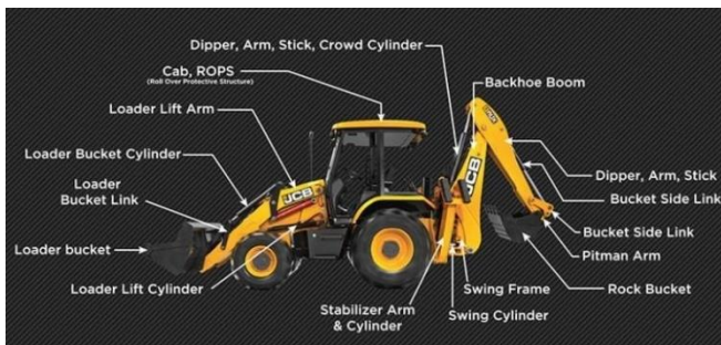
Gambar 5.15 Komponen Back Hoe
