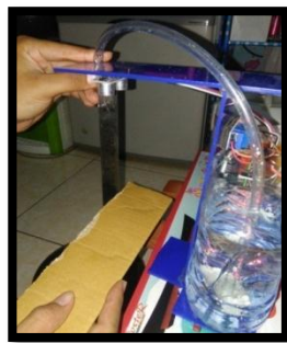
Gambar 10. Pengujian rangkaian Sensor HCSR-04 jarak jauh dan dekat
