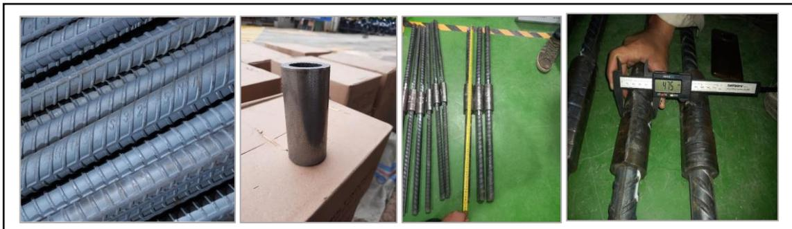
**Gambar 3. Besi Tulangan Diameter 32 mm yang tersambung *mechanical Coupler Grip* Tipe RII**
