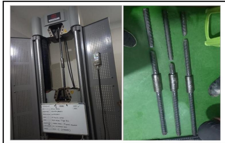
**Gambar 4. Benda Uji Terpasang Pada Mesin Uji Tarik dan hasil benda uji yang terputus**
