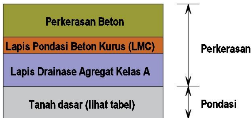
Gambar Struktur perkerasan kaku (beton) untuk lalu lintas berat (Bina Marga, No.02/M/BM/2013)
